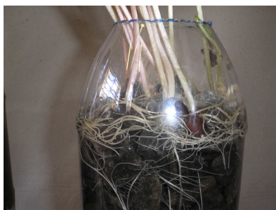
Figura 4.2 – Célula que apresenta cascalho e vegetais fixadores de nitrato
