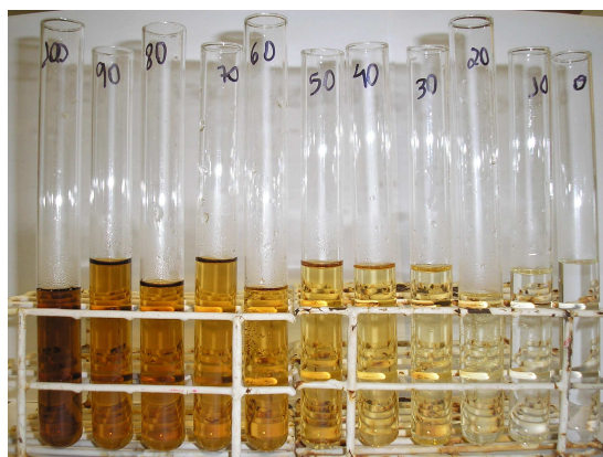
Figura 4.5 – Aspecto visual do efluente após a primeira hora do experimento (foto superior: efluente não fotoativado, foto inferior: efluente fotoativado)
