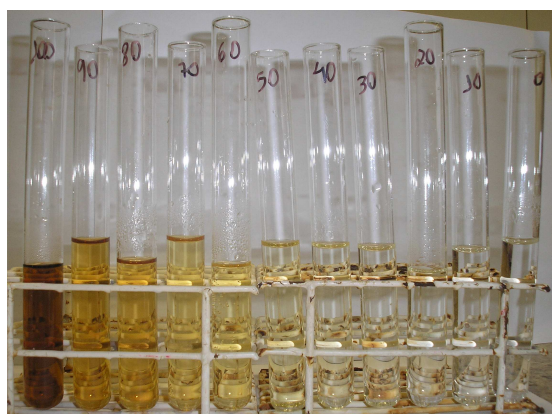
Figura 4.6 – Aspecto visual do efluente após a quinta hora do experimento (foto superior: efluente não fotoativado, foto inferior: efluente fotoativado)
