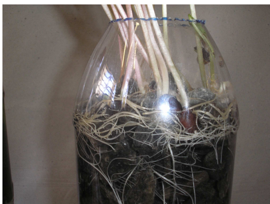
Figura 4.5 – Célula que apresenta cascalho e vegetais fixadores de nitrato
