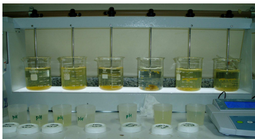
Figura 2.1 – Teste em Jarros de coagulação/floculação
