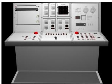
Figura 4 - Mesa de controle do reator Argonauta modelada (virtual).
