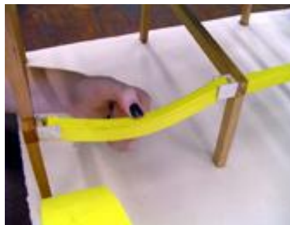
Figura 2.1 – Viga simplesmente apoiada
