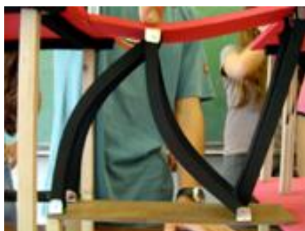
Figura 2.14 – Treliça (barras comprimidas)
