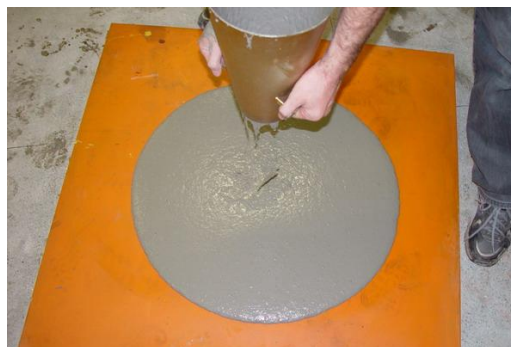
Figura 4.1 – ensaio de espalhamento utilizando o tronco de cone de Marsh.
