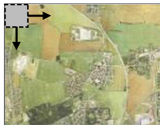
Figura 3 – Aplicação de uma janela de deslocamento na imagem em análise, para obtenção de medidas de características.
