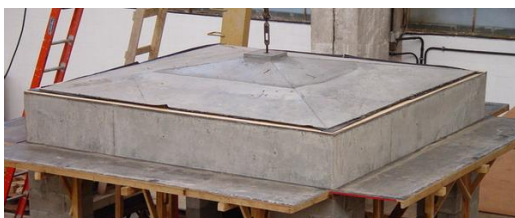
Figura 6.11 – Casca em forma de tronco piramidal projetada, construída e ensaiada na COPPE/UFRJ [14].
