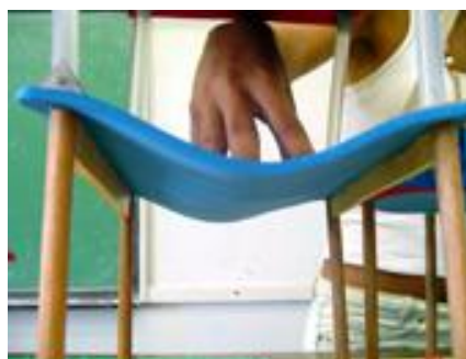
Figura 2.16 – Laje maciça (flexão em uma direção)
