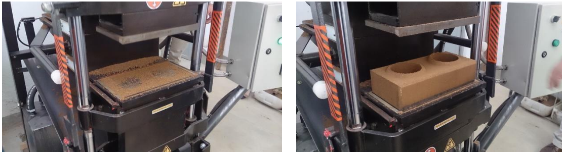
Figura 2 - Moldagem do tijolo ecológico.
