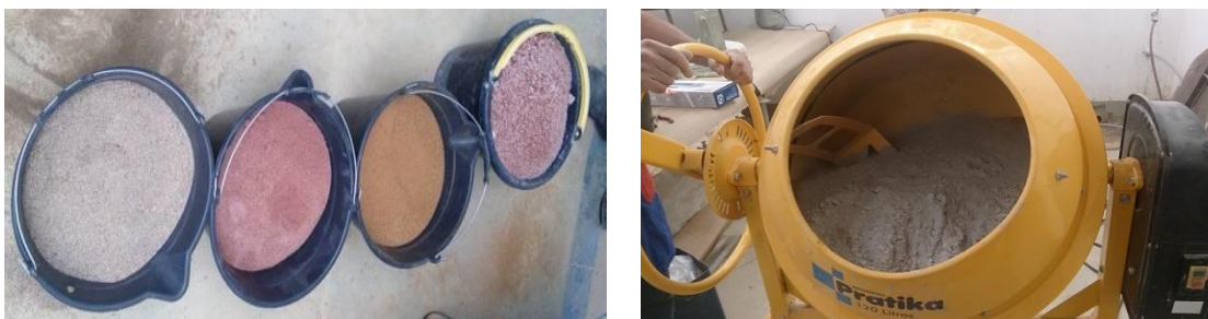
Figura 1 - Sequência da mistura dos componentes do tijolo ecológico.
