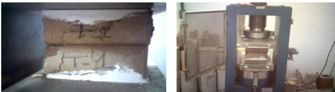
Figura 3 - Ensaio de compressão dos corpos de prova.
