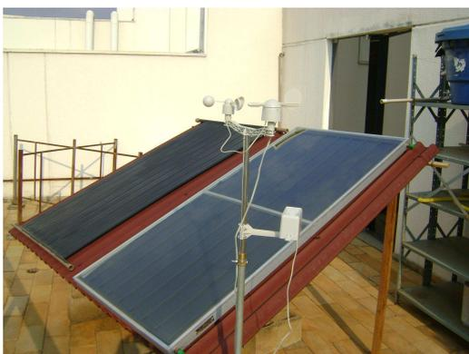
**Figura 2.1** – Bancada de ensaios em seu formato final com os dois coletores solares (PVC e Metal), o reservatório d’água e os dispositivos de aquisição de dados.
