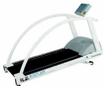
**Figura 3.5** – Plataforma tipo esteira [13] que mede a reação vertical do piso devido ao caminhar de forma contínua, vide figuras 3.7 (a,b).
