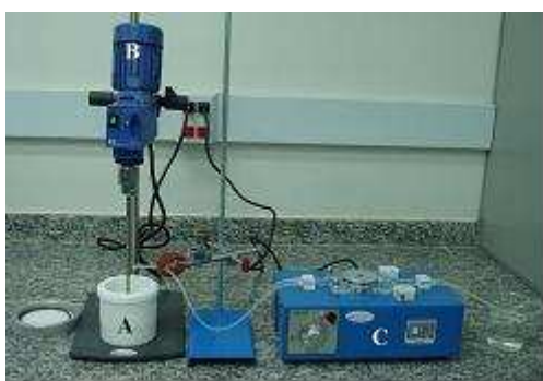
Figura 2.1. Sistema utilizado na síntese de hidrotalcita. Reator (A), agitador mecânico (B) e bomba peristáltica (C).
