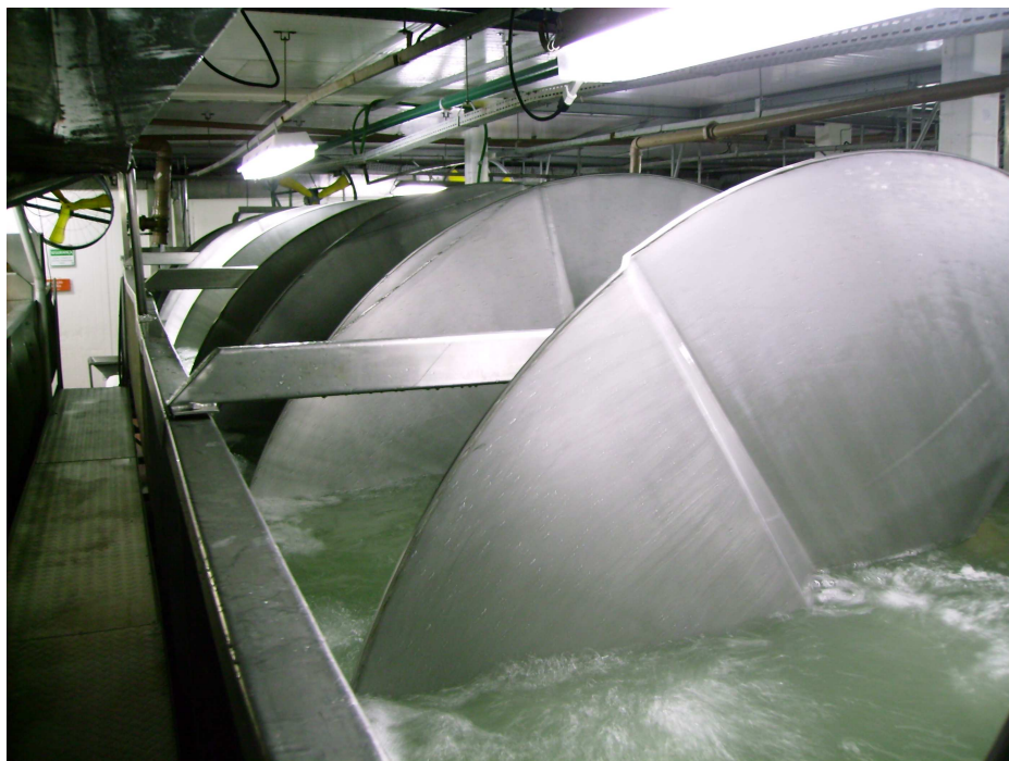
Figura I – Foto do Chiller de carcaças de frango.
