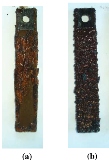
Figura II – Cupons de AC, após 31 dias de exposição às condições das BT`s 02 (a), e 03 (b) nos experimentos do estudo preliminar.
