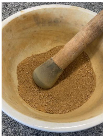
Figura 2. Destorroamento do Solo
