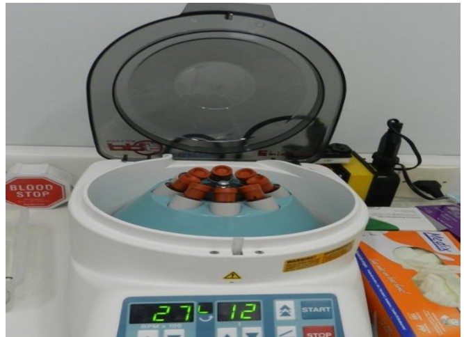
Figura 9- Tubos posicionados na centrífuga programada para 2700 rpm durante 12 minutos.
