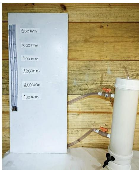
Figura 7 – Permêmetro de Carga Constante. (Fonte Autor ,2023)
