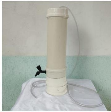
Figura 5 – Permeâmetro de Carga Variável montado. (Fonte Autor ,2023)
