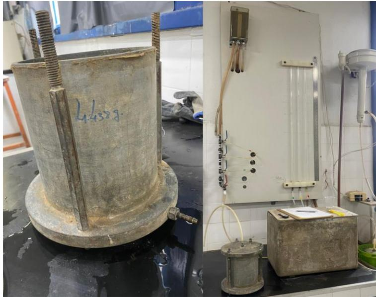
Figura 2 – Permêmetro de Carga Constante
