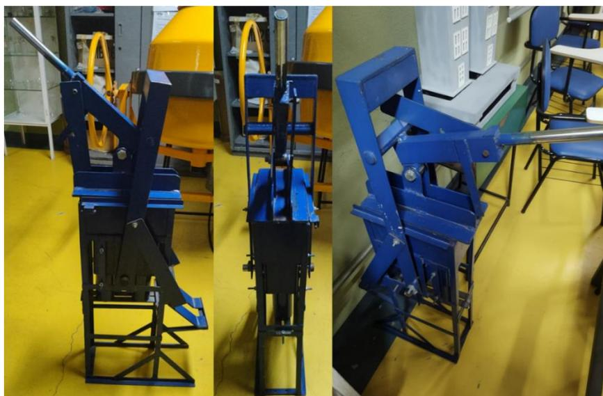
Figura 1. Prensa manual existente Fonte Autor ,2023
