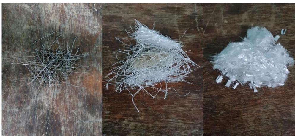
Figura 1 – Fibras de aço, de vidro e de polipropileno (Fonte Autor ,2023)
