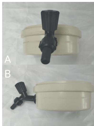
Figura 4 - A imagem A mostra a vista frontal da base do permeamêtro já equipada com a torneira, enquanto a imagem B exhibe a vista lateral da mesma. (Fonte Autor ,2023)
