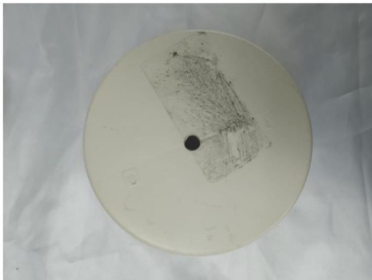
Figura 3 – Cap de PVC destinado a ser utilizado como topo do permeâmetro, já provido do orifício para entrada de água.
