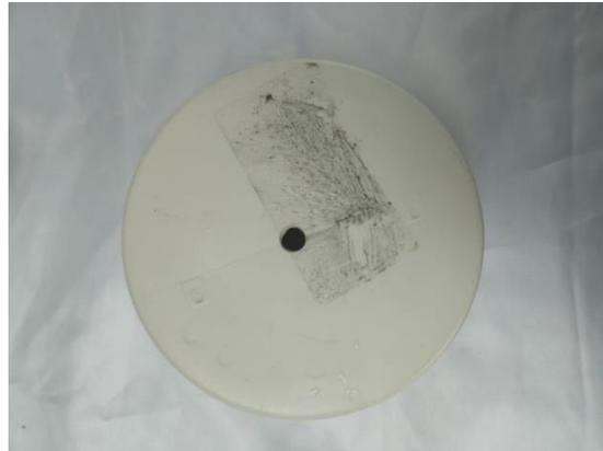
Figura 3 - Cap de PVC que será usado como topo do permeâmetro, já com o furo para entrada de água. (Fonte Autor ,2023)
