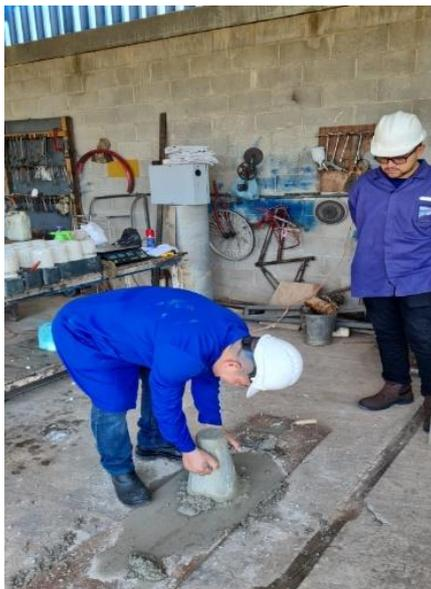
Figura 2 – Teste slump
