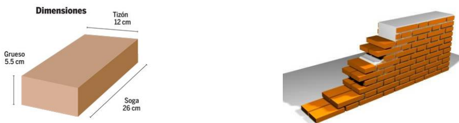
Figuras 3 y 4. Dimensión de tabique de barro recocido y su colocación. Fuente: (Hernández, 2011).
